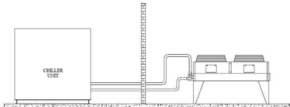
Σχήμα 5 - Συμπυκνωτής τοποθετημένος χωρίς υψομετρική διαφορά
