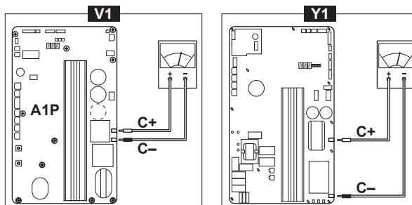
3 Για να αποτρέψετε τυχόν βλάβη στην πλακέτα PCB, προτού αφαιρέστε ή συνδέστε τους συνδετήρες αγγίζετε ένα μεταλλικό εξάρτημα χωρίς επίστρωση για να εξουδετερώσετε τον στατικό ηλεκτρισμό.
